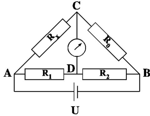
ist als der unbekannte Zweig einer Wheatstone'sche Brücke geschaltet. Bei entspanntem Muskel ist die Wheatstone'sche Brücke abgeglichen (es fließt also kein Strom durch das Amperemeter), wenn  $R_1/R_2 = 1,48$  und  $R_0 = 40,7\Omega$  gilt. Bei angespanntem Muskel ist sie bei  $R_0 = 40,736\Omega$  abgeglichen. Wie weit hat sich der Muskel gedehnt?
