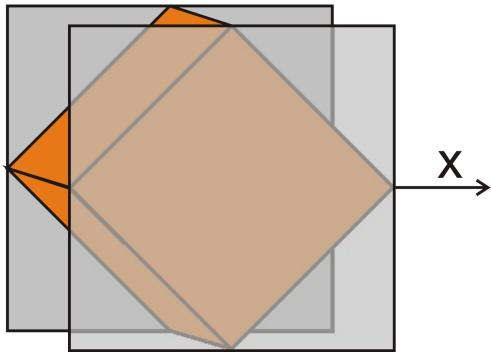
Ein Dielektrikum mit Dielektrizitätskonstante  $\epsilon_r$  und Masse  $m$  befindet sich in einem Plattenkondensator, an dem eine konstante Spannung  $U$  anliegt. Die Platten des Kondensators sind quadratisch mit Seitenlänge  $\sqrt{2}a$  und das ebenfalls quadratische Dielektrikum hat Seitenlänge  $a$  und ist um  $45^\circ$  gegen die Platten gedreht (siehe Abbildung). Es füllt den Abstand  $d$  der Platten vollständig aus. Randeffekte sind zu vernachlässigen.
