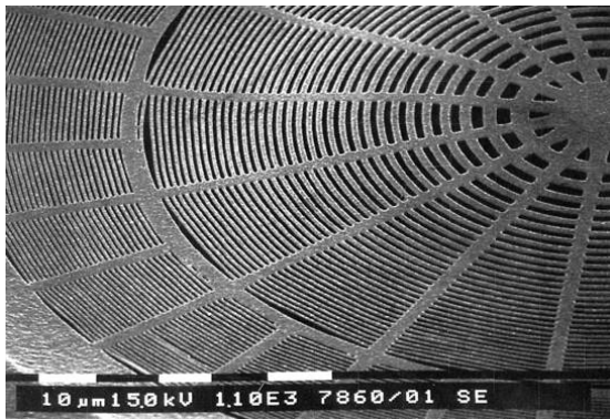
Abbildung 7.148: Fresnel'sche Zonenplatte als Linse für Atome.
