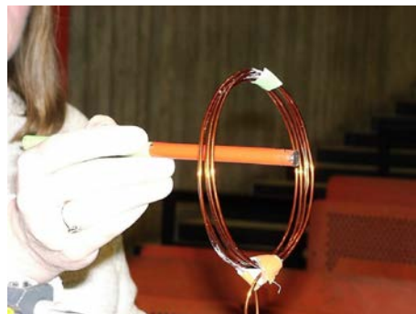
Abbildung 4.164: Ein Magnet wird in eine Leiterschleife geschoben und induziert dadurch eine Spannung.
