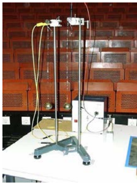
Abbildung 4.5: Anziehung und Abstoßung zwischen geladenen Kugeln.
