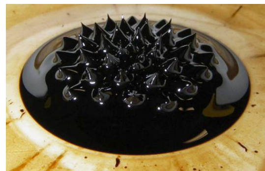
Abbildung 4.156: Oberfläche eines Ferrofluids im Feld eines Stabmagneten.
