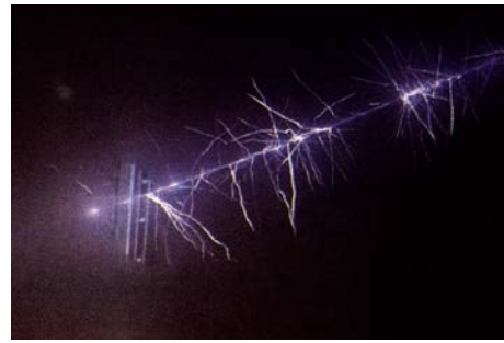
Abbildung 4.24: Koronaentladung eines Drahtes.
