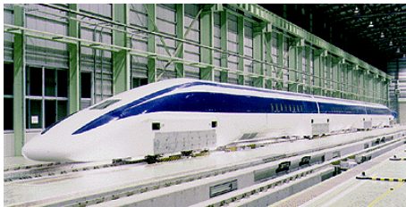
Abbildung 4.162: Zug schwebt mit Hilfe von supra-leitenden Magneten.
