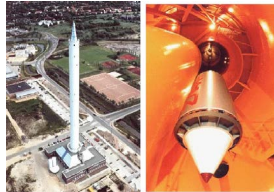
Abbildung 2.103: Links: Fallturm in Bremen. Rechts: Kapsel im Fallturm.
