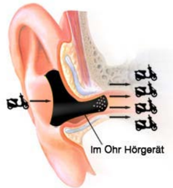
Abbildung 8.36: Schallverstärkung durch Hörgerät.
