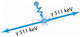
Abbildung 13.40: Annihilation eines Positrons und Erzeugung eines Paares von \gamma -Quanten.
